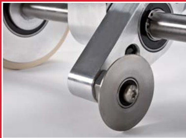
The guide roller holds the TAPEMAT «Spiegel» on course.
